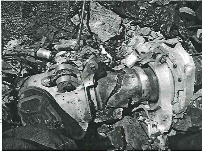
Fractura en el mástil de transmisión
